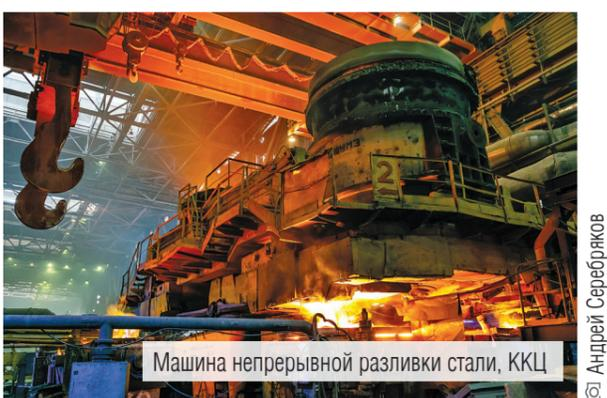
Машина непрерывной разливки стали, ККЦ
