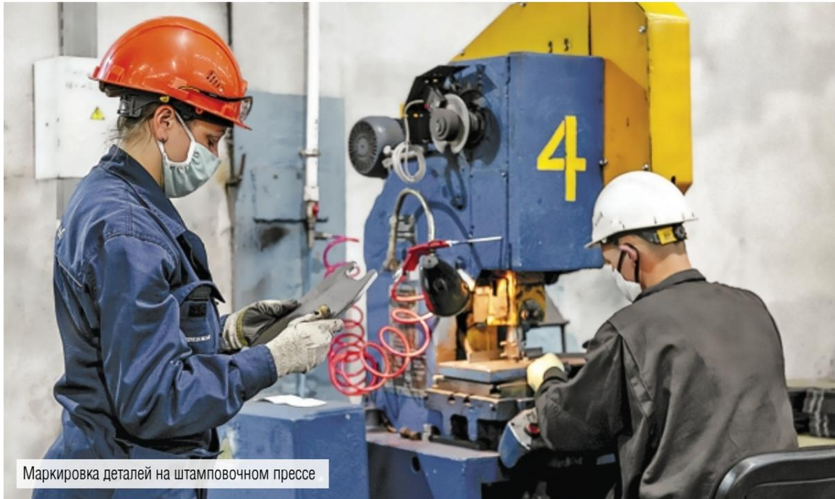
Маркировка деталей на штамповочном прессе
