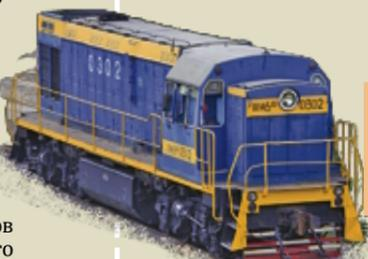
**ТТМ6** четырёхосный тепловоз с гидравлической передачей, сконструированный на Людиновском тепловозостроительном заводе
