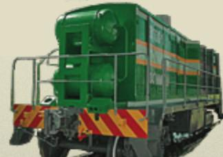
**Дизель-генераторная установка** используется для перемещения электровоза внутри цеха, где отсутствуют контактные линии
