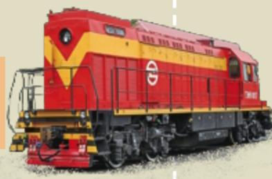
**ТЭМ9** — четырёхосный маневрово-вывозной тепловоз с электрической передачей переменного тока и индивидуальным приводом колёсных пар, предназначен для работы на железных дорогах промышленных предприятий чёрной и цветной металлургии
