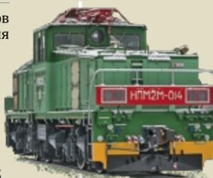
**Промышленные электровозы серии НРМ** предназначены для работы на железнодорожных путях металлургических предприятий и открытых горных разработок
