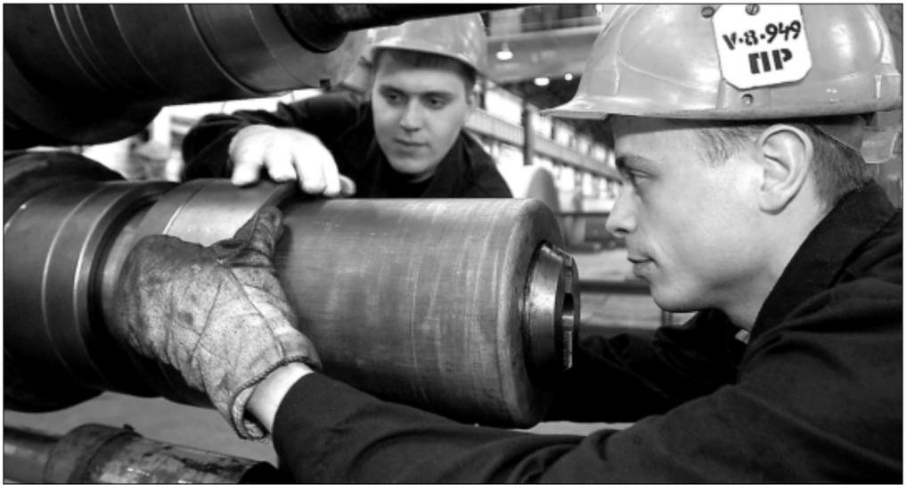
Для вальцовщика валок – основной инструмент в клетях прокатных станов
