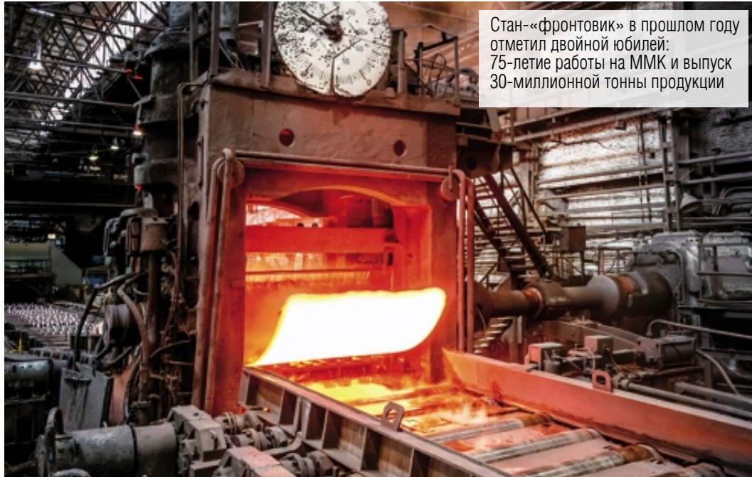
На стане «2350» производится горячекатаный лист толщиной от 8 до 30 миллиметров
