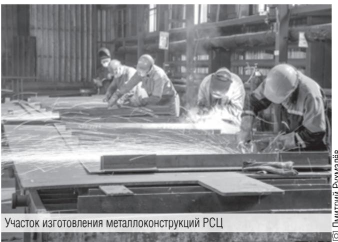
Участок изготовления металлоконструкций РСЦ
