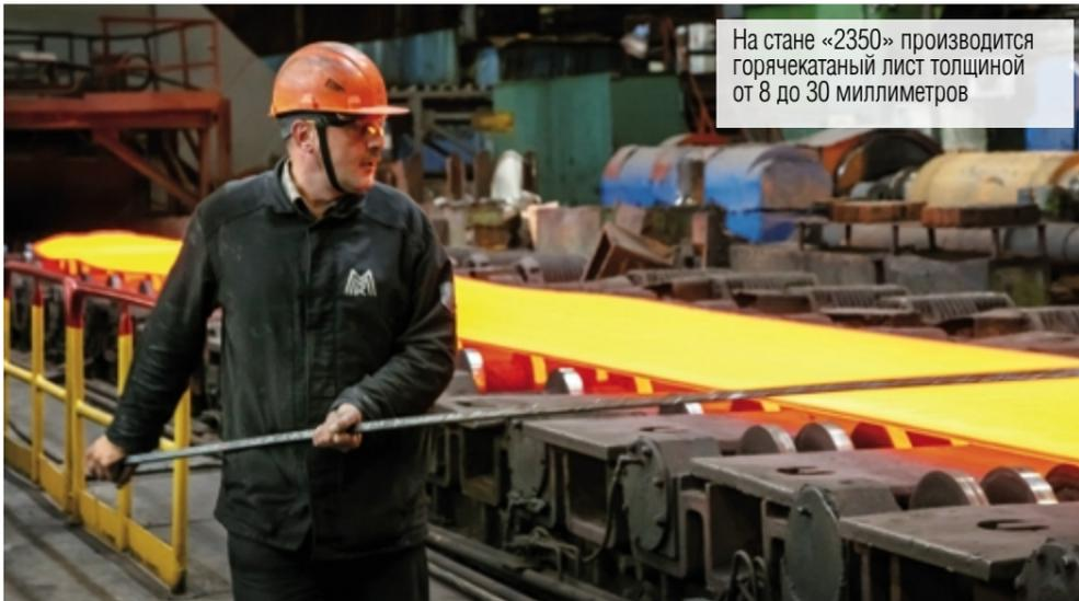
На стане «2350» производится горячекатаный лист толщиной от 8 до 30 миллиметров
