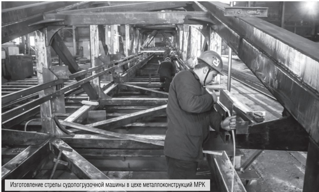
Изготовление стрелы судопогрузочной машины в цехе металлоконструкций МРК
