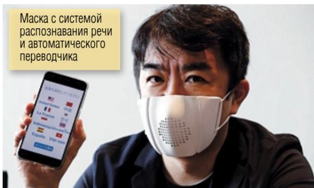
Маска с системой распознавания речи и автоматического переводчика
