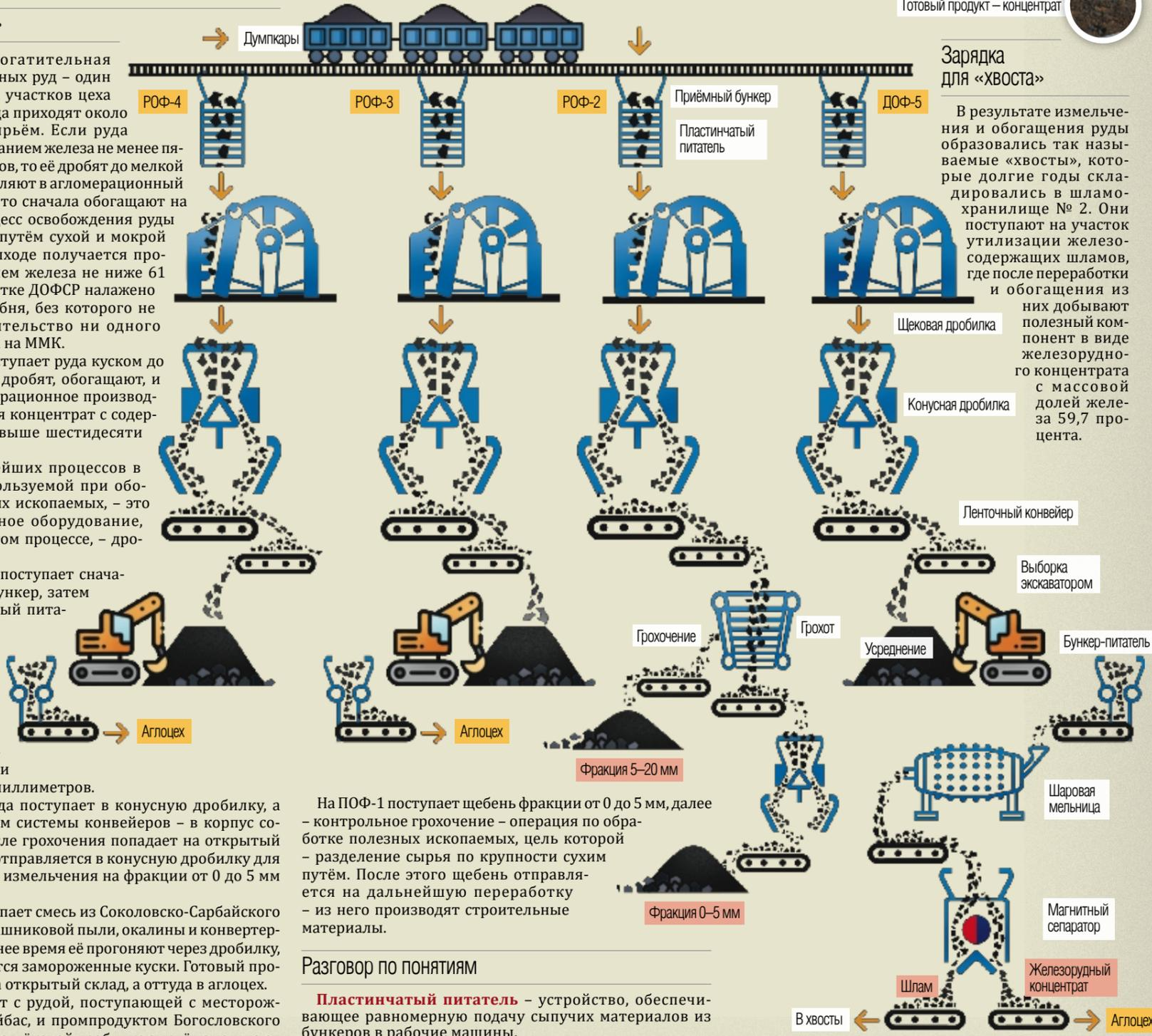
назначенная для дробления твёрдых пород методом раздавливания их на мелкие части нужных фракций. Попадая в пространство между подвижной конической поверхностью и конусообразной неподвижной чашей, куски пород измельчаются.
