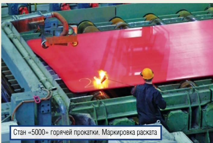
Стан «5000» горячей прокатки. Маркировка раската
