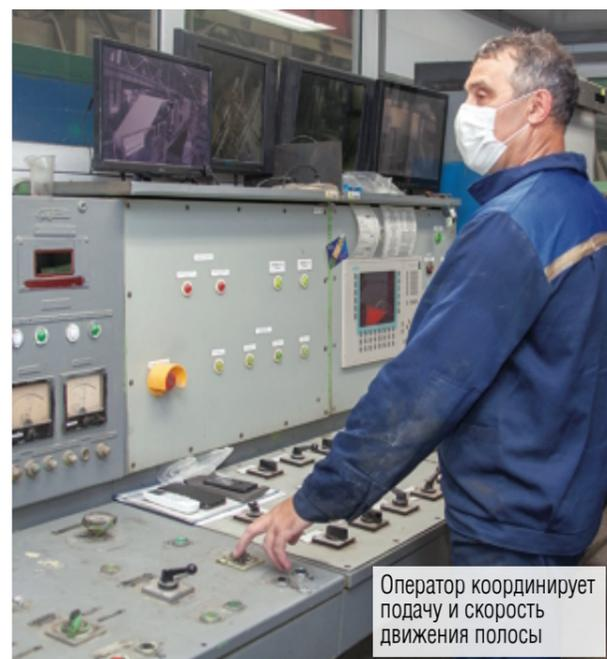
Оператор координирует подачу и скорость движения полосы
