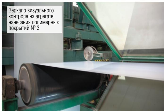
Зеркало визуального контроля на агрегате нанесения полимерных покрытий № 3
